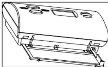
1. Retire el soporte/cubierta posterior de la unidad deslizando un destornillador entre la unidad y la cubierta en el hueco en el centro de la unidad. Esto permite el acceso a la parte posterior de la unidad.
