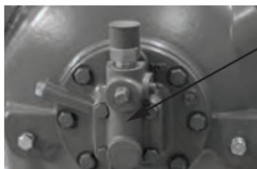
BLOQUE DEL SENSOR DE PRESIÓN DE ACEITE INSTALADO EN FABRICA PARA EL INTERRUPTOR DE SEGURIDAD DE PRESIÓN DE ACEITE (OPSS) QUE ESTÁ DISPONIBLE. PARA OBTENER MÁS INFORMACIÓN, CONSULTE LA SECCIÓN 3.12
