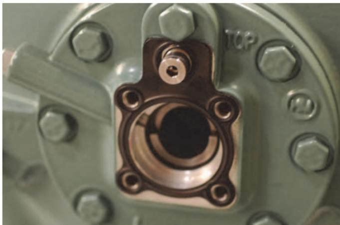
**Fig. 18: Empaquetadura del bloque del sensor del interruptor OPSS**
