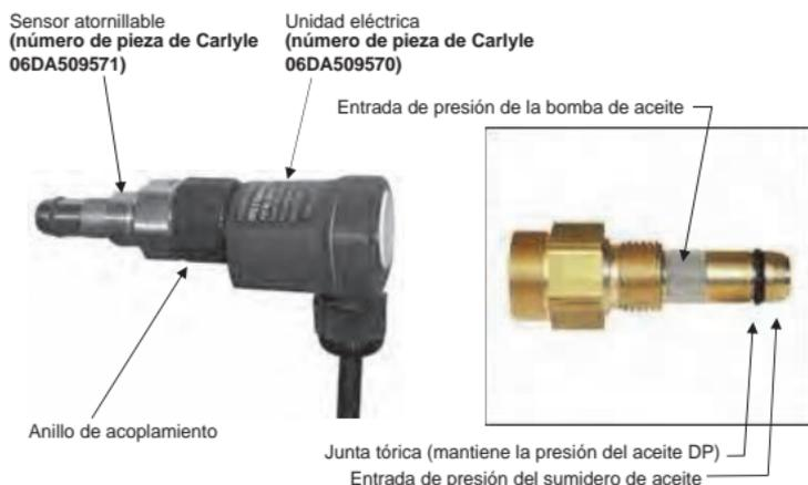
**Fig. 16: Interruptor de seguridad de presión del aceite**
