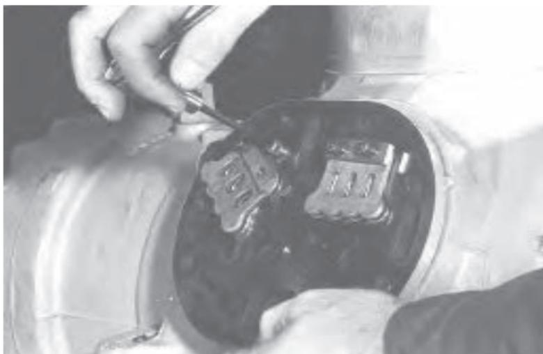
**Fig. 2: Desmontaje de la placa de válvula
