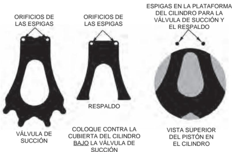
**Fig. 5: Posiciones del pistón, la válvula de succión y la válvula de respaldo (06E)**
