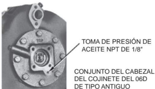
**Fig. 9: Puntos de conexión del compresor de 4 cilindros 06D (13 a 16 Cfm)**
