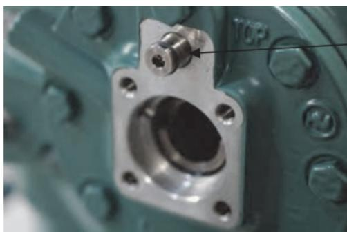
Instale la conexión de la junta tórica NPT de 1/4" (n.º de pieza 06EA407204)
