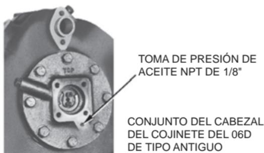
**Fig. 8: Puntos de conexión del compresor de 2 cilindros 06D**
