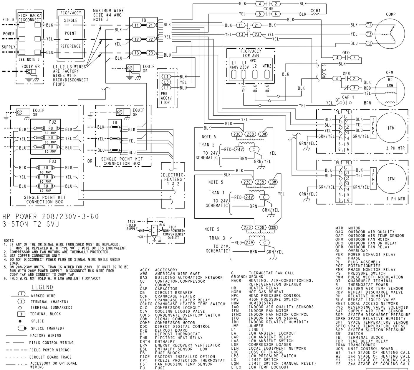
**Fig. K — 50GCQ 04-06 SystemVu™ Power Wiring Diagram — 208/230-3-60**
