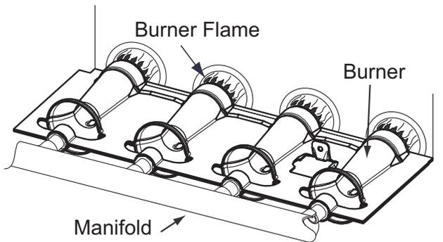
**Fig. 17 – Burner Flame**
