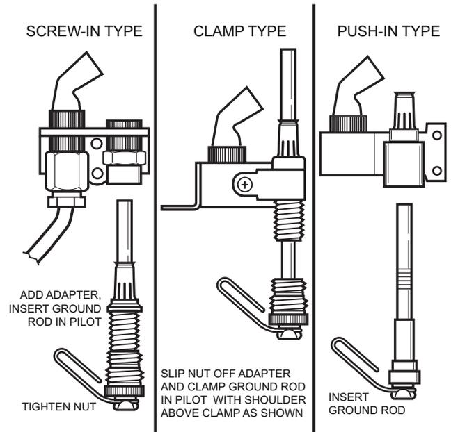
BE SURE THE GROUND CLIP IS SNAPPED ONTO THE PILOT BURNER OR ITS GAS LINE.
