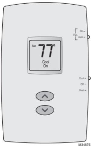
Régler le sélecteur du ventilateur **FAN** pour que le ventilateur fonctionne en continue ou seulement au besoin.
