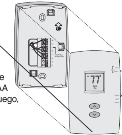
Gire el termostato e inserte baterías AAA alcalinas nuevas; luego, vuelva a instalar el termostato.
