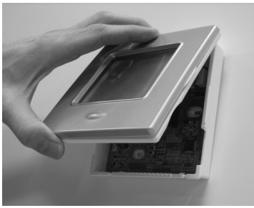
Fig. 15 - Reattach Display Module
