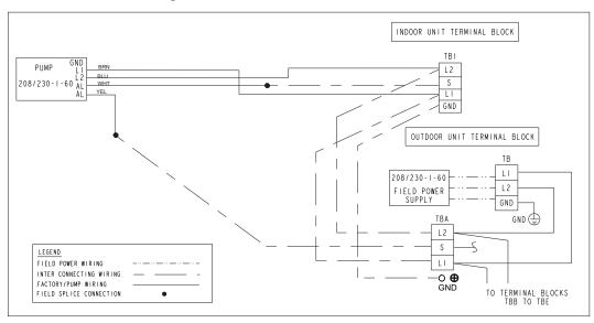
Fig. 20 - (208/230-1-60) WIRING SCHEMATIC
