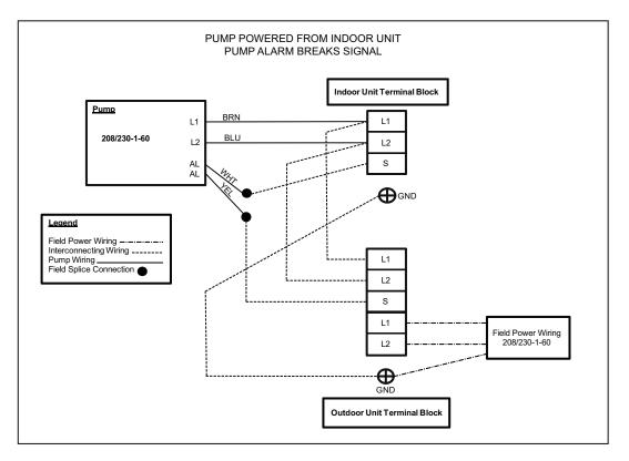
Fig. 15 - (208/230-1-60) WIRING SCHEMATIC
