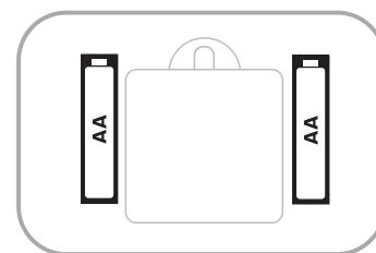
Insérez des piles AA pour l'alimentation principale ou de secours
