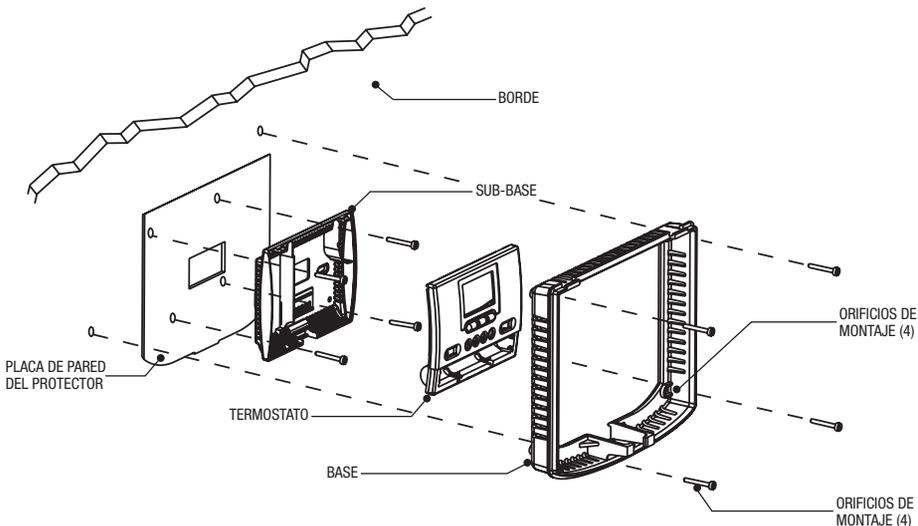
1. Ponga la sub-base del termostato en la placa del guarda termostato y use la sub-base como guía.
