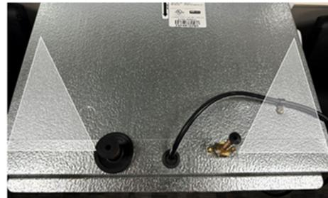
1. Insérez le capteur dans la fente avec le câble dirigé vers le bas, puis pliez la languette supérieure ou installez la vis fournie comme illustré ci-dessous pour verrouiller le capteur en place.
