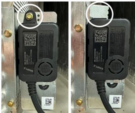
3. Fixez le câble du capteur à l'aide du collier de serrage fourni et de la vis dans la zone générale indiquée ci-dessous. Assurez-vous de créer une boucle de gouttelette conformément aux instructions précédentes. Veillez à ce que la vis ne perce pas la bobine de l'évaporateur.
