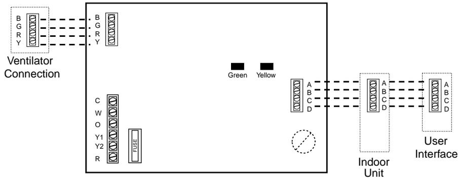
**Fig. 2 — Ventilator (HRV / ERV) Connection**
