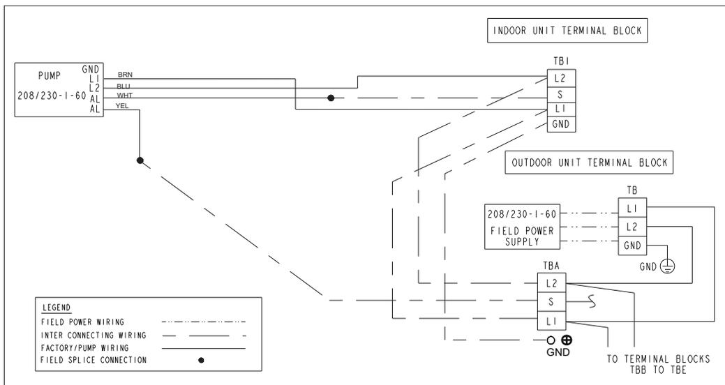
**Fig. 20 – (208/230-1-60) WIRING SCHEMATIC**
