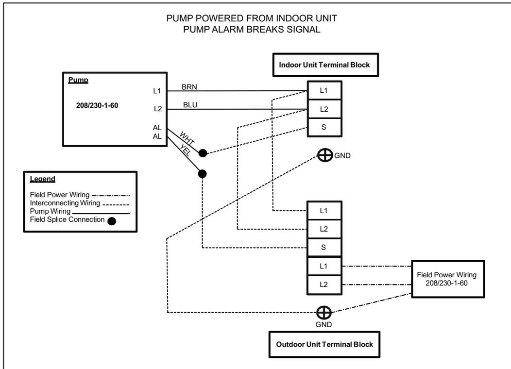
**Fig. 15 – (208/230-1-60) WIRING SCHEMATIC**
