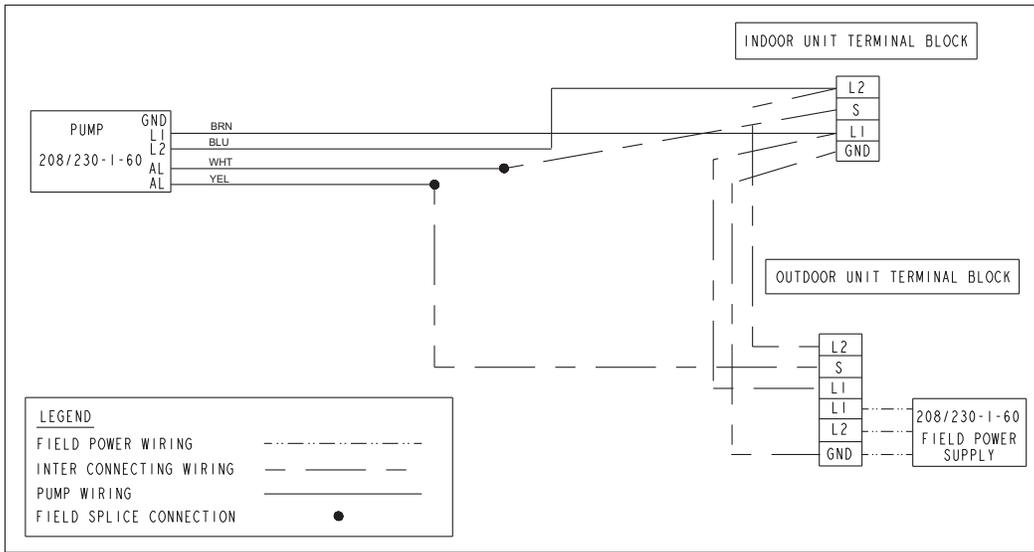
**Fig. 19 – (208/230-1-60) WIRING SCHEMATIC**
