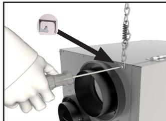
**2** Utilisez un tournevis plat et tirez légèrement sur la languette perforée. Mettez le maillon de la chaîne sous le crochet.
