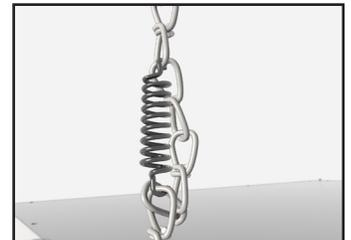
**4** Installez un ressort sur chaque chaîne. Accrochez le ressort de sorte qu'une boucle est créée dans la chaîne. Le ressort supportera le poids du AAF et absorbera les vibrations.
