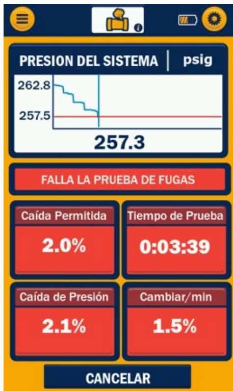
Figura 24: Prueba de caída de presión - FALLA
