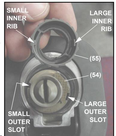
**REMOVING THE STEEL QUIK-LOK® BLADE CLAMP**
